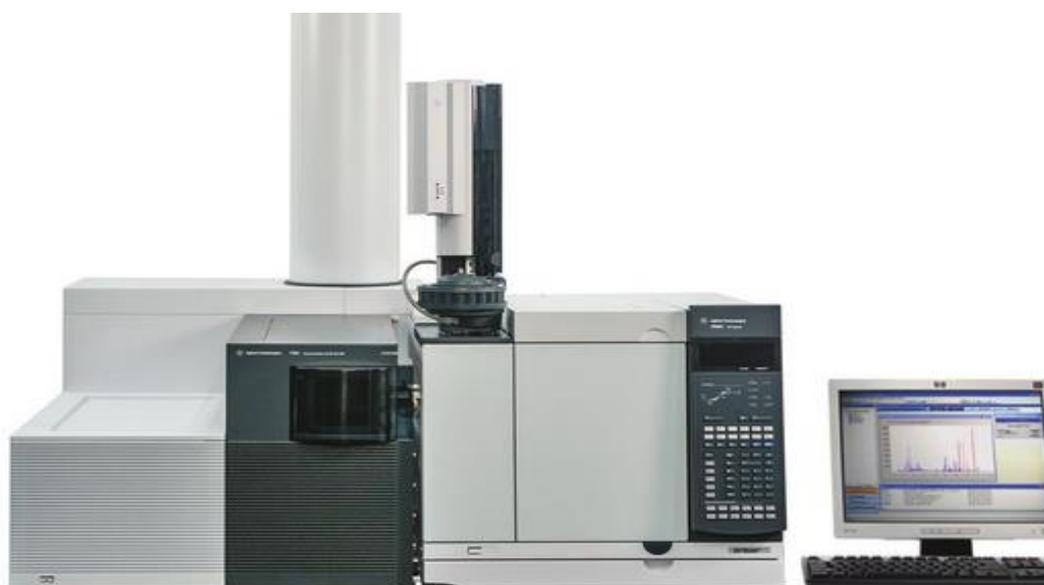
**Figure V.6:** Chromatographe en phase gazeuse 7890A.
