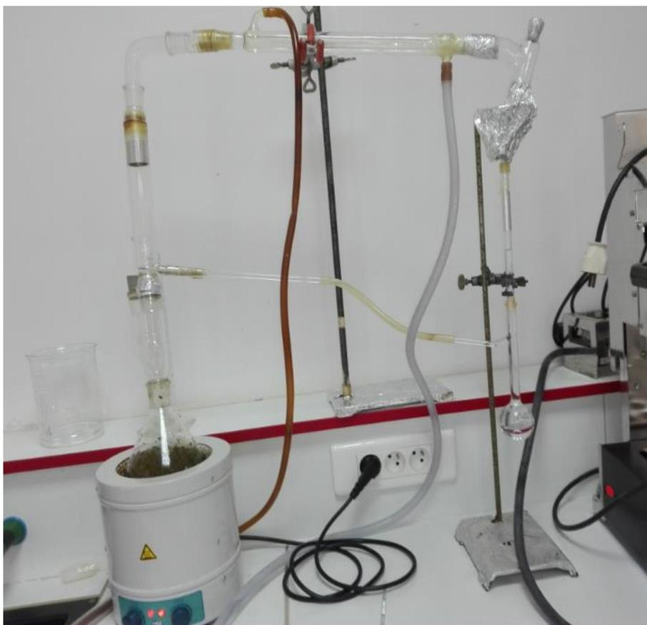
**Figure V.4:** Dispositif d'hydrodistillateur de type Clevenger pour l'extraction de l'huile essentielle
