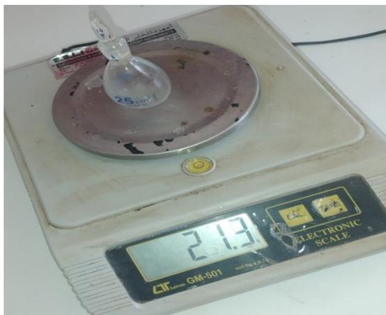
Fig. 29–Mesure de la densité à l'aide de Pycnomètre
