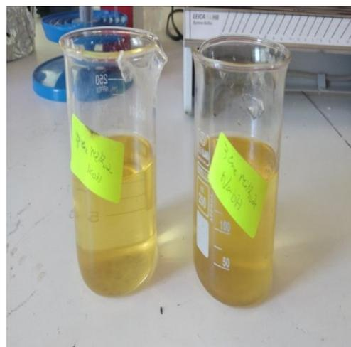
Fig. 21 – Produit final : le biodiesel
