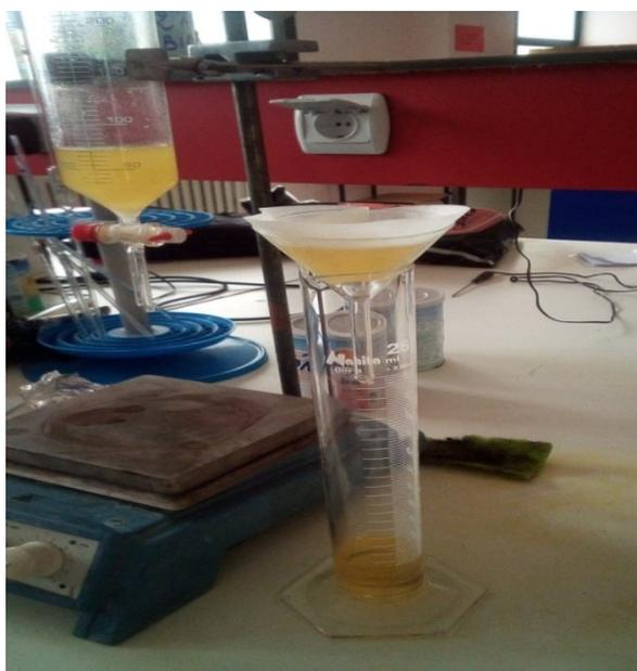
Fig. 19 – Filtration du biodiesel
