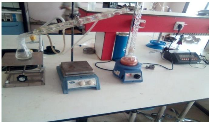
Fig. 28 – la procédure de distillation
