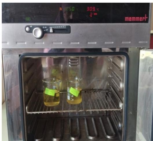
Fig. 20 – Séchage du biodiesel
