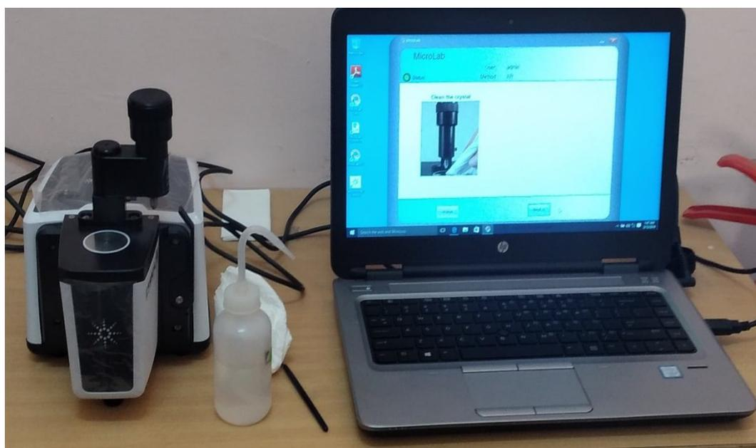
Fig.24 – Analyse spectroscopique IR du biodiesel
