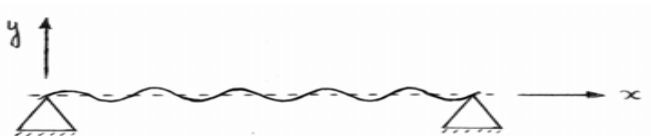
Figure.II.2 -Vibration transversale d'une poutre
