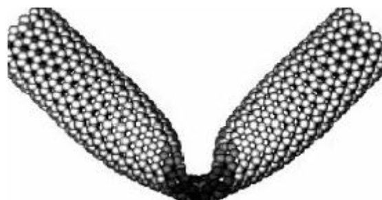
Figure I.5: Contrainte mécanique qui induit une flexion dans un nanotube de carbone.
