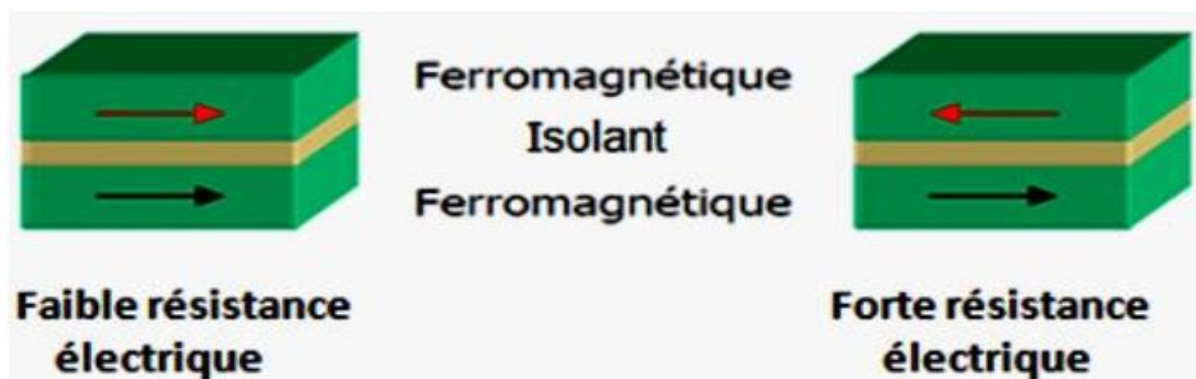
Fig. I. 9. Les deux états, parallèle et antiparallèle, dans une jonction tunnel magnétique.
