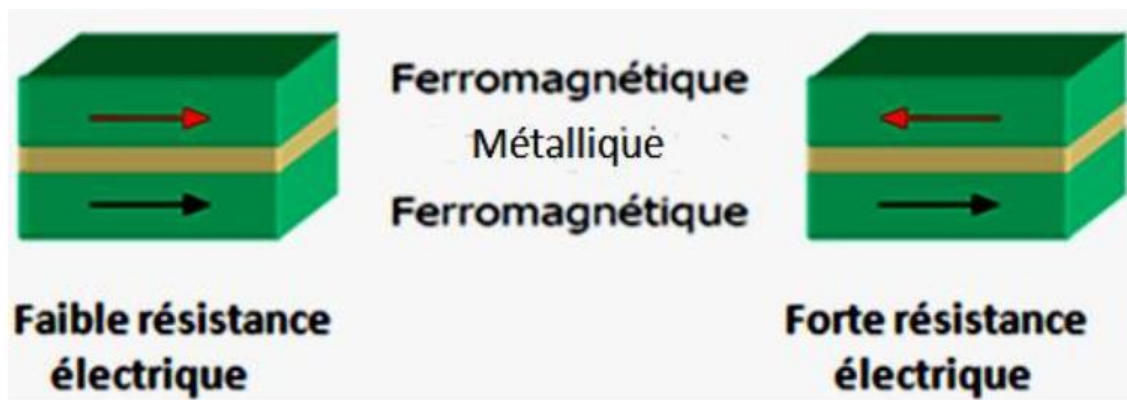
Fig. I. 8. Les deux états, parallèles et antiparallèles dans une jonction géante magnétique
