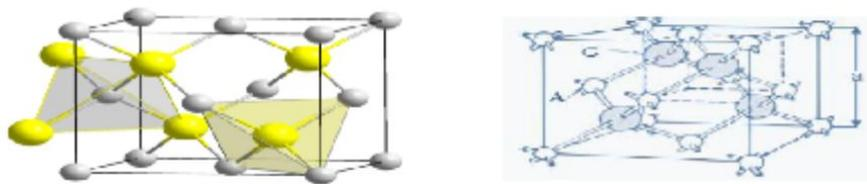
Figure I.3 : Structure Cristalline du GaAs
