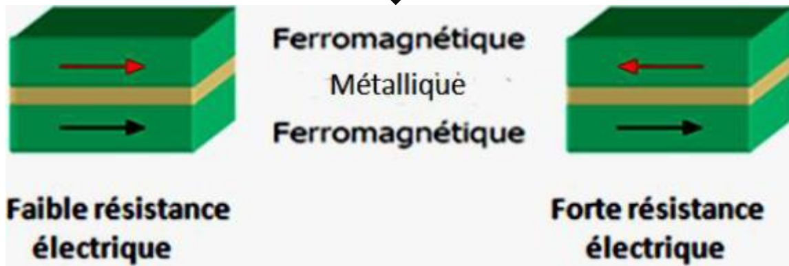
Fig. I. 11: les deux états, parallèle et antiparallèle, dans une jonction géante magnétique.
