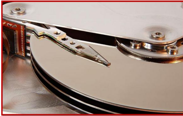
Figure.I.2: Détail d'un bras avec sa tête reposant sur un plateau de disque dur[3].
