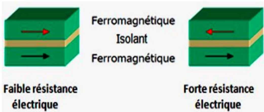
Figure I.14 : Les deux états, parallèle et antiparallèle, dans une jonction tunnel magnétique.
