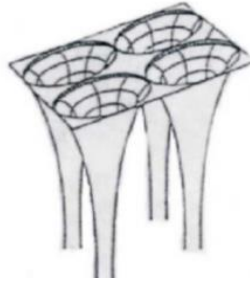
Figure.II.3. Schéma d'un potentiel Muffin-Tin[46].
