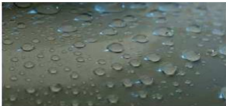
Figure I.9: Hydrophobicité d'une surface en silicone. (10)
