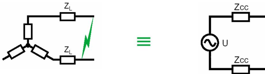
Figure II.10 : Court-circuit biphasé isolé
