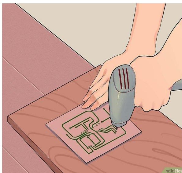
Figure III- 20 :l'opération de perçage des trous. . [4]
