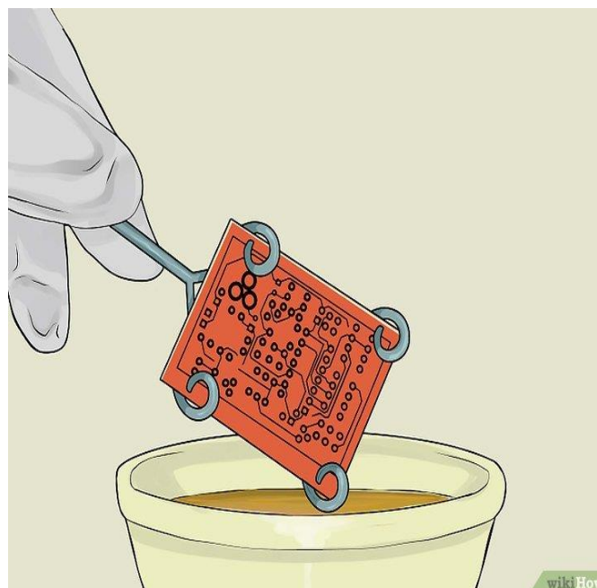
Figure III-18 : l'opération d'élimination de cuivre.
