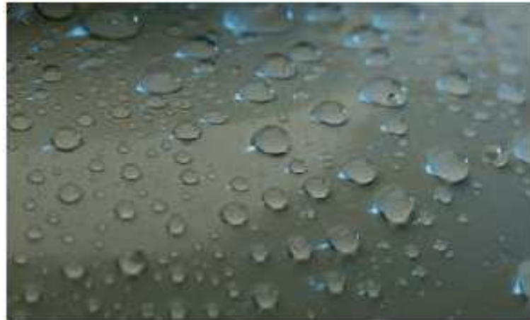
Figure I.12: Hydrophobicité d'une surface en silicone (9).
