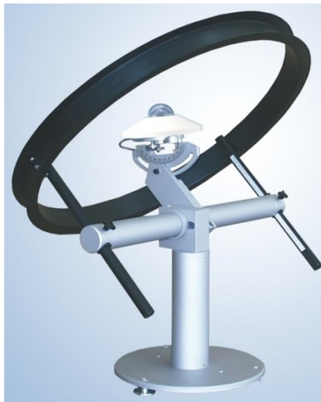
Figure I.14 Pyranomètre avec anneau d'ombrage.
