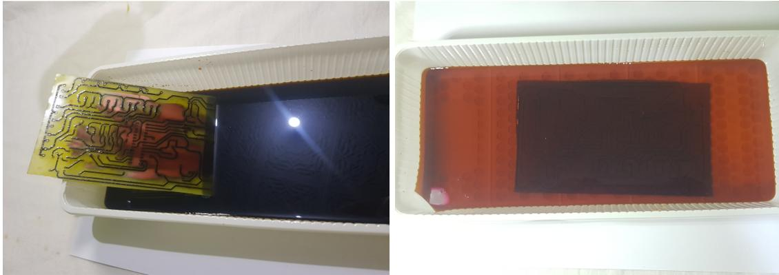
FIGURE 4.15 – Baignade de la plaque dans le perchlorure de fer
