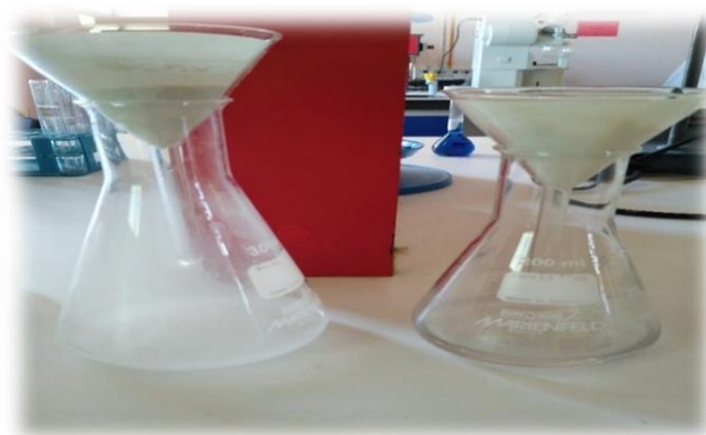
Figure III.3 : Filtration classique de mélange
