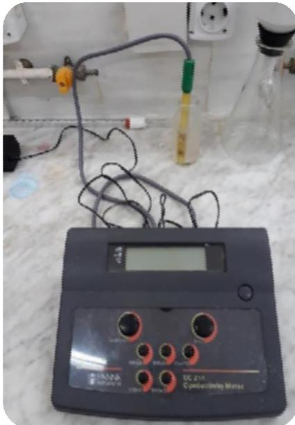
Figure 03: Conductimètre
