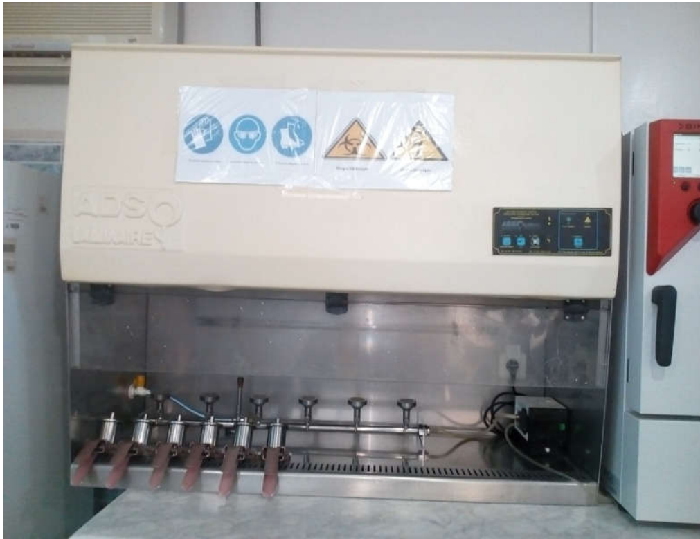
Figure N°07: système de filtration ;Rampe à filtration- pompe a vide – la haute,(Originale ;2021)
