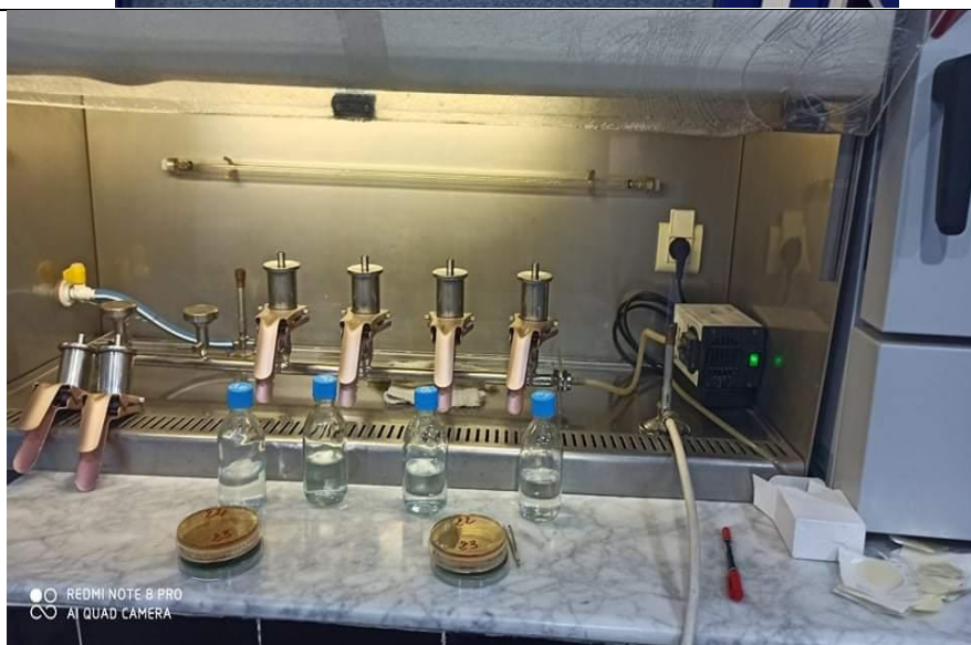
Filtration sur la membrane
