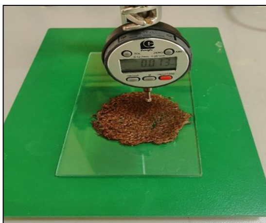
Figure 9. Mesure de l'épaisseur des films par le comparateur.
