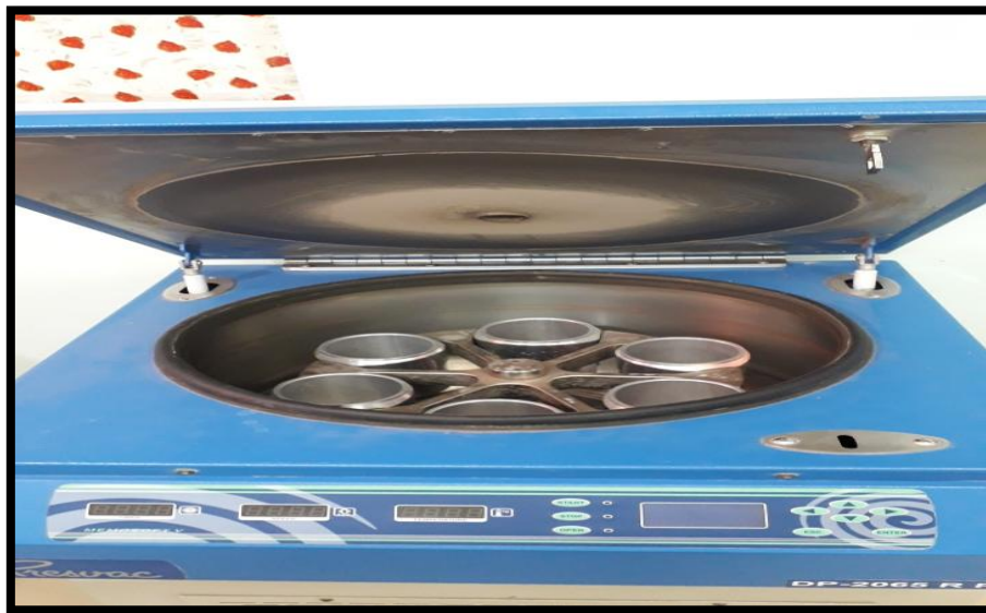
Figure 13: Centrifugeuse des poches« PRESVAC» .photo de service effectué le 10/05/2022.
