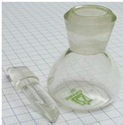
Figure N°07 : Pycnomètre en verre
