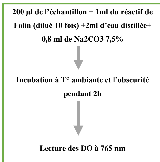
Figure21 : Différentes étapes du dosage des polyphénols totaux (PPT) des deux extraits aqueux et méthanolique et Éthanloïque (Singleton et al., 1965).
