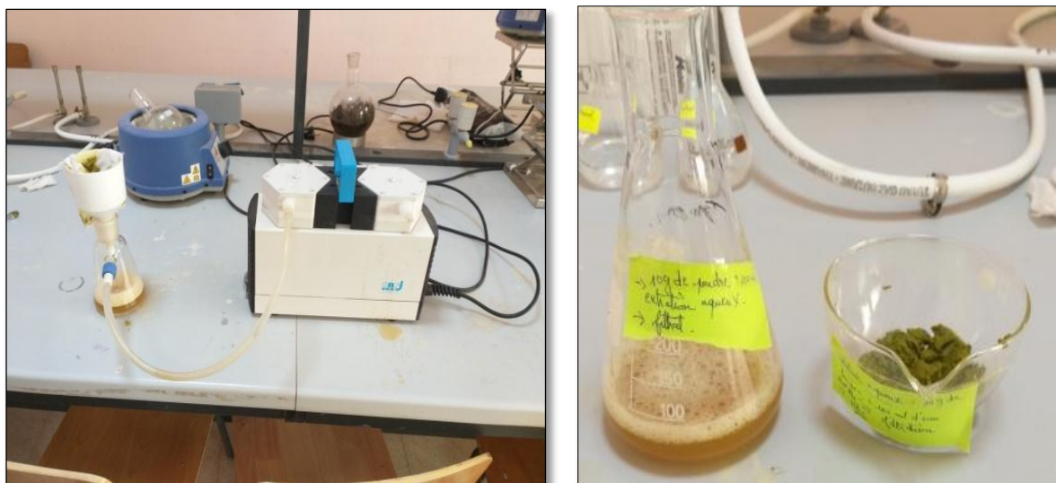
Figure16 : la filtration de l'extrait aqueux a l'aide de la pompe sous vide (originale, 2022)
