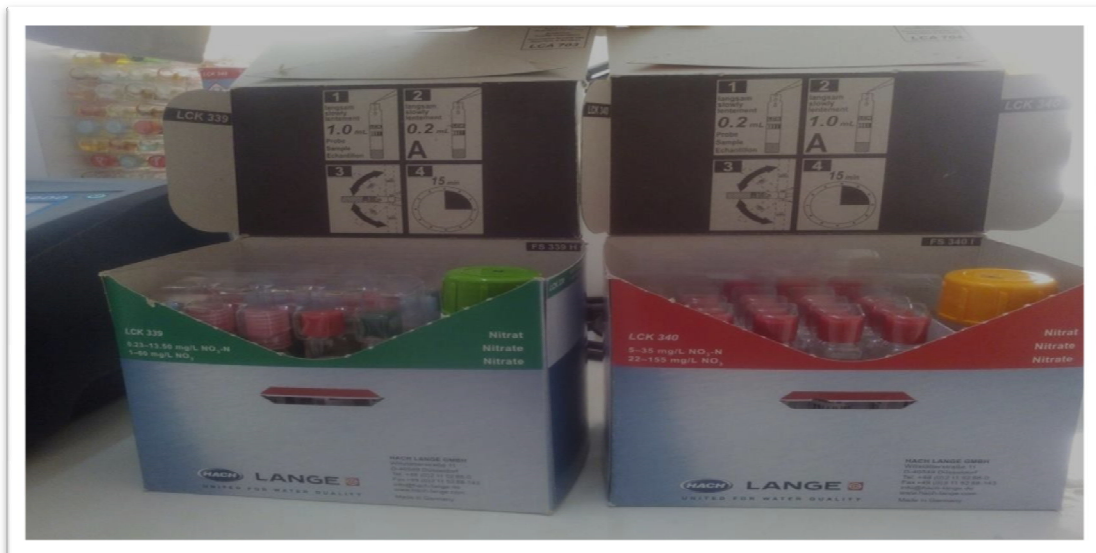
Figure « 33 » : kits mesure nitrite (LCK 339/340).
