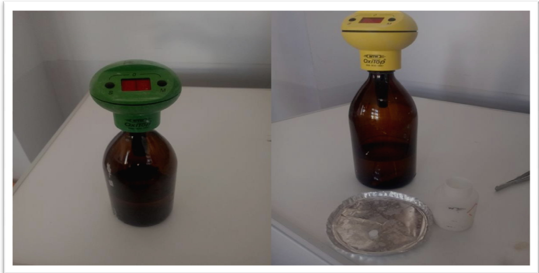
Figure « 32 » : Têtes Oxytop de couleur verte et jaune
