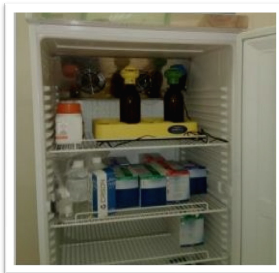
Figure « 30 » : Armoire thermostatique
