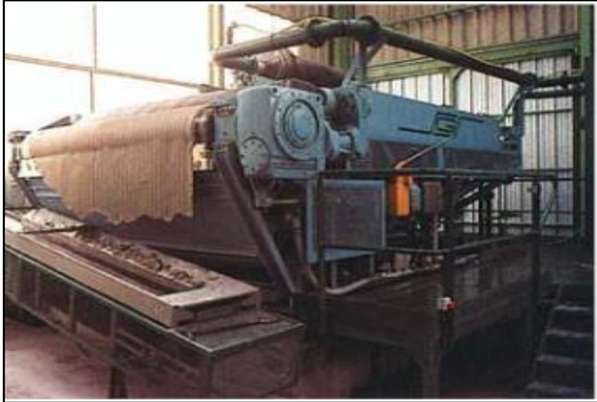
Figure 09: Déshydratation par filtre presse (in Jardi, 2002).
