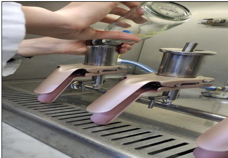
Figure N°14 : Versement des échantillons d'eau dans la rampe de filtration
