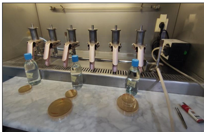
Figure N°13 : Rampe de filtration
