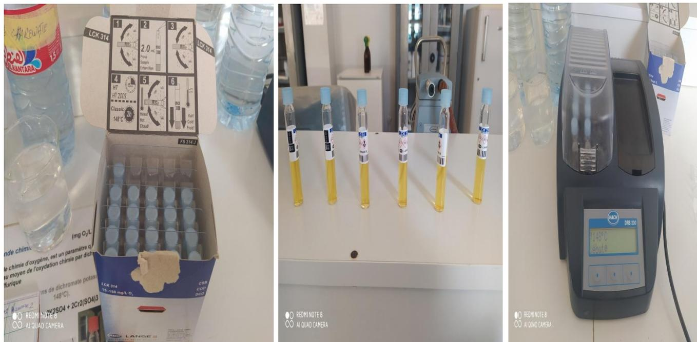
Figure 25 : Déterminé le dosage de DCO
