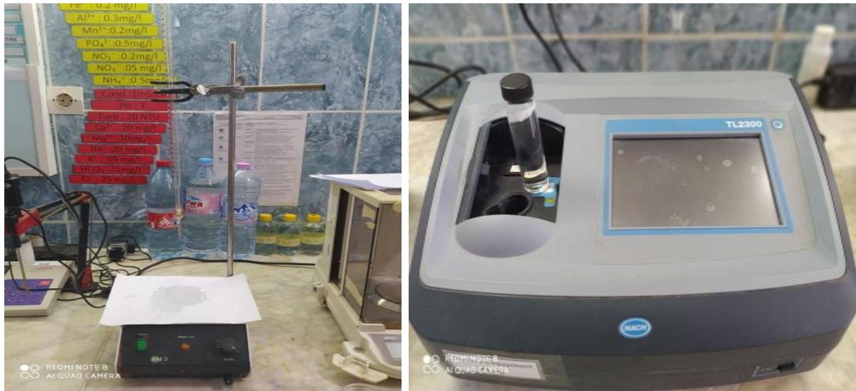
Figure 19 : Dosage de Sulfate. (Khelif et Labboun ,2021).
