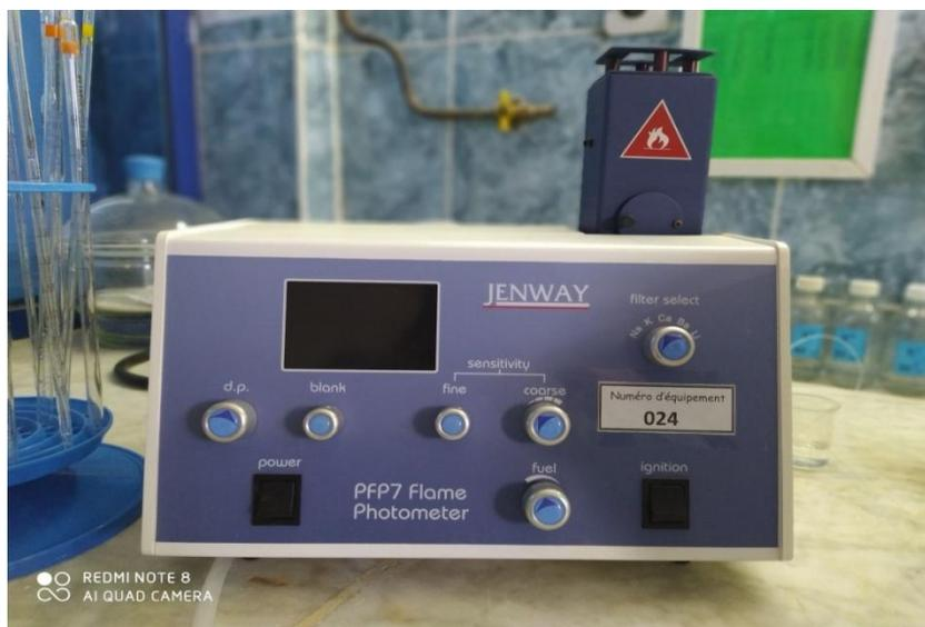
**Figure 23: Dosage du Sodium spectrophotomètre en flamme. (Khelif et Labboun ,2021).**
