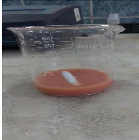
**Figure 18 : Dosage du Chlorure. (Khelif et Labboun ,2021).**
