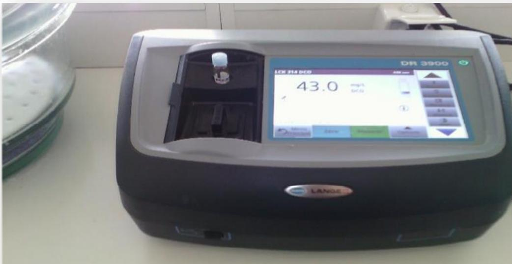
**Figure N° 12 : mesure de la DCO**
