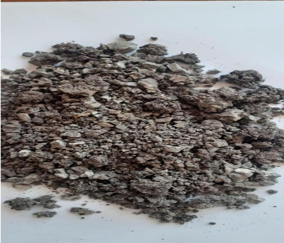
**Figure N° 11:** les boues de la station d'épuration des eaux usées de Tissemsilt
