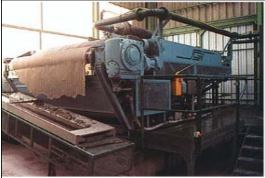
Figure 15 : Déshydratation par filtre presse. (in Jardi , 2002).
