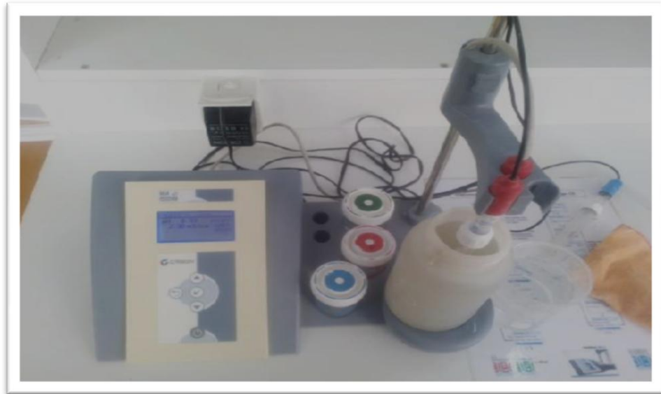
Figure 1 : multi paramètres : mesurer le PH, T°C, CE, TDS, salinité
