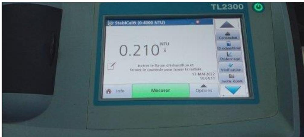
**Figure N°18 : Turbidimètre HACH TL2300**
