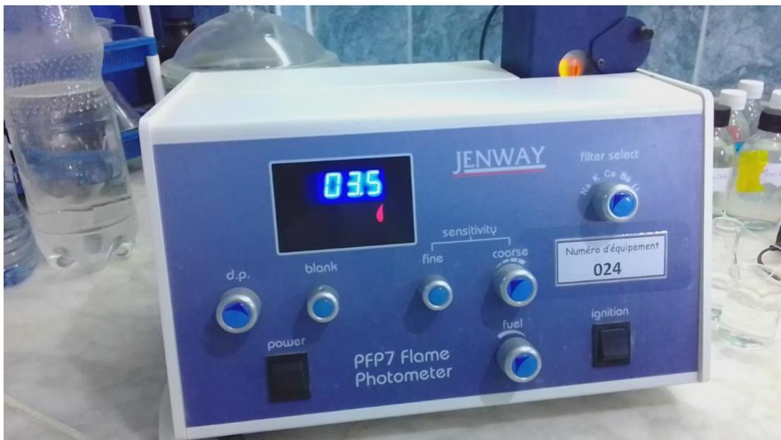
Figure N°24 : Dosage de sodium par photométrie de la flamme
