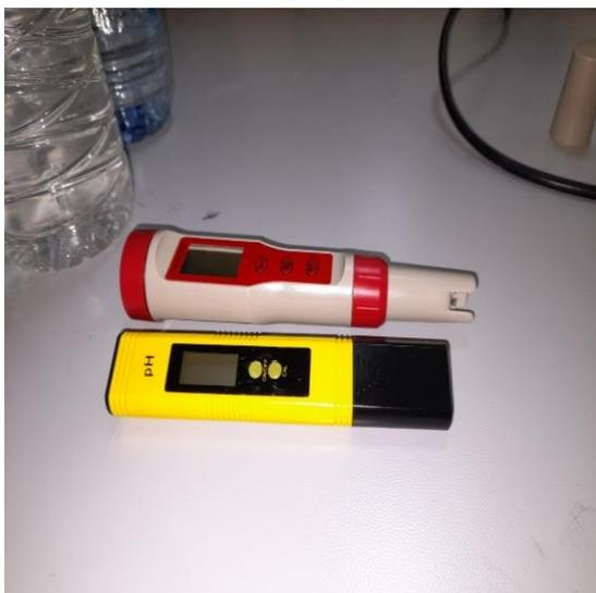
pH mètre et conductimètre
