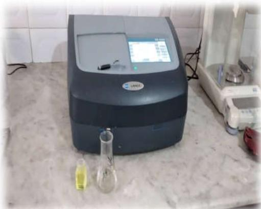
**Figure N°18** :photographie de Spectrophotomètre
