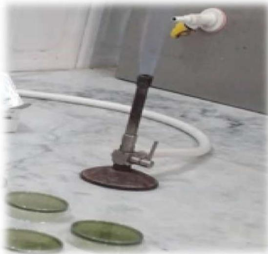
**Figure N°23** : photographie de Bec de benzène (prise par DJALIL et DRAOUI 03\_2022)
