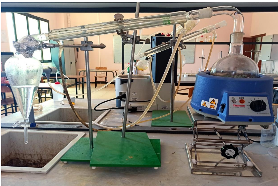
Figure 13 : Appareil d'hydrodistillation de type Clevenger.
