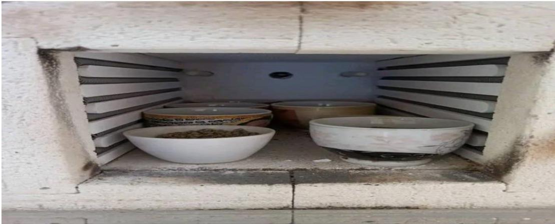
**Figure n° 05** : Photo illustrant la détermination des matières volatiles sèches
