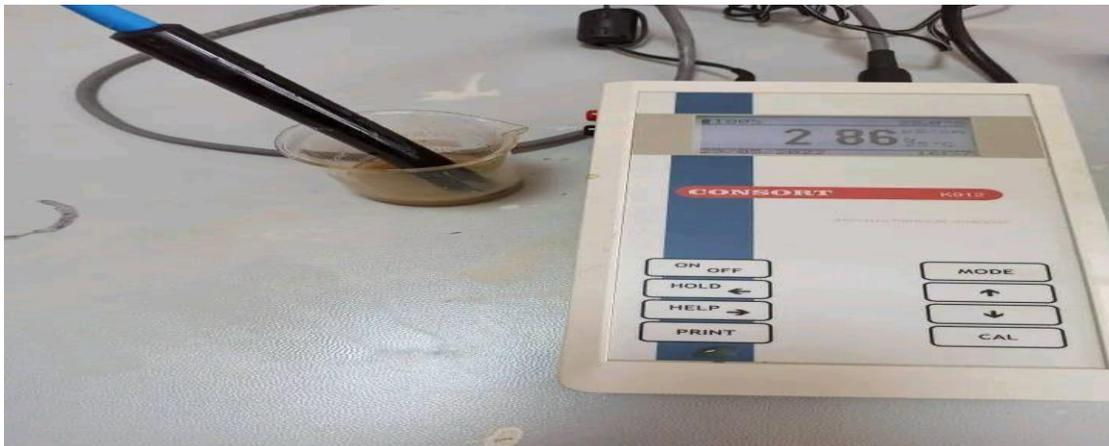
**Figure n° 06**: Conductimètre.
