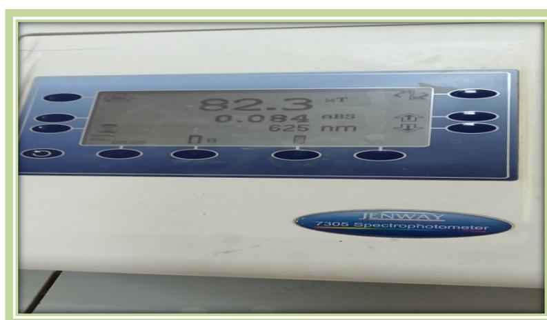
**Figure n°18 : Lecture de la densité optique des suspensions bactériennes sur un spectrophotomètre (Original)**
