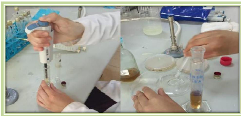
**Figure n°22 : Technique pour réaliser une gamme de dilution (Original)**
