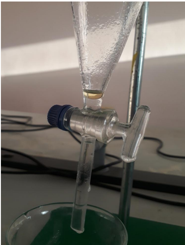
Figure n°11: Dispositif d'hydrodistillateur de type Clevenger pour l'extraction de l'huile essentielle (Originale 2022)
