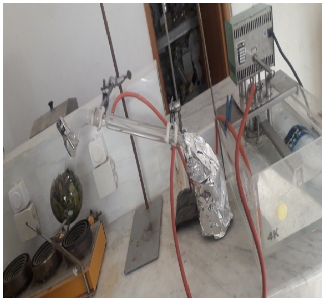
Figure 4: Schéma du montage d'hydrodistillation de type clevenger ( originale )
