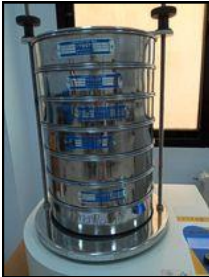
Figure N° 11 : La série des tamis utilisée dans l'analyse granulométrique (P.P)
