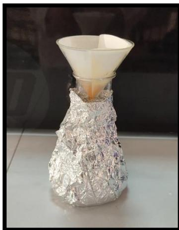
**Figure N°16** : Filtration de solution du pistachier.
