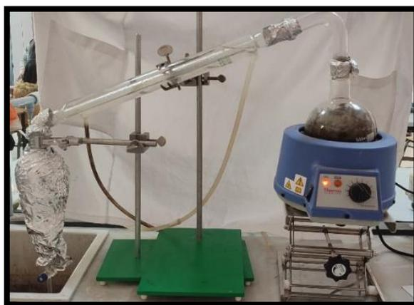
Figure N°14 : L'extraction de l'hydrolat de lavande.
