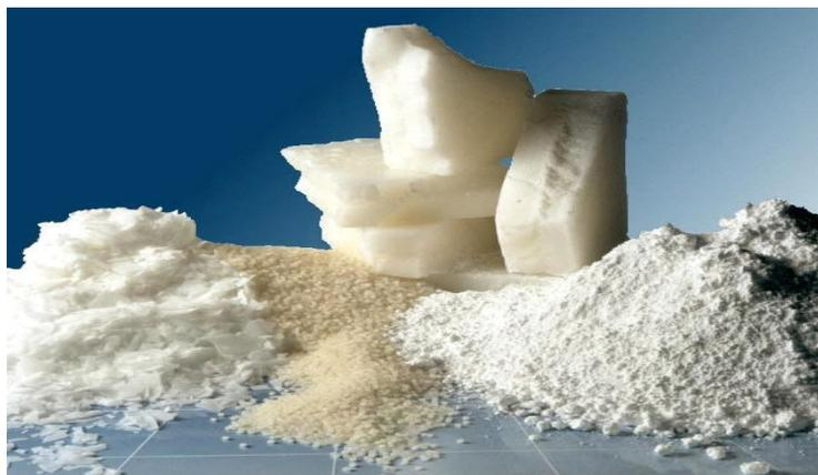
Fig.2.6- matériau a changement de phase RT. [12]
