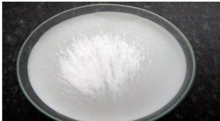
Fig.2.7- matériau a changement de phase SP. [12]
