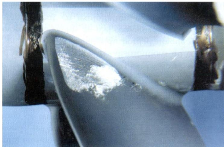
**Fig.2.3-Cavitation à poche partielle. [25]**
