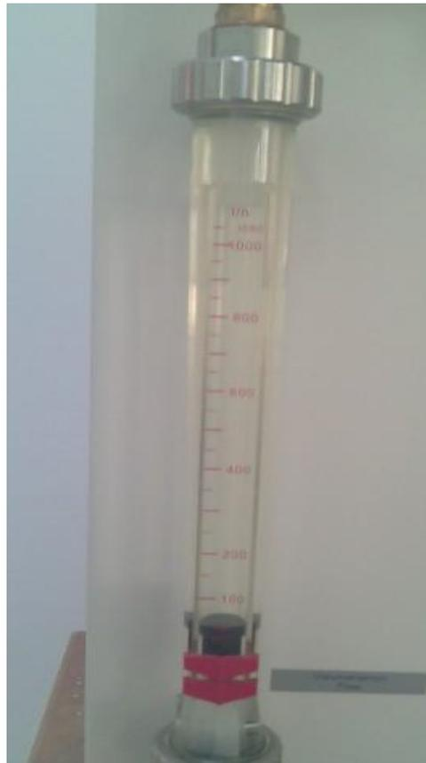
**Fig.3.4-débit mètre à corps flottant.**
