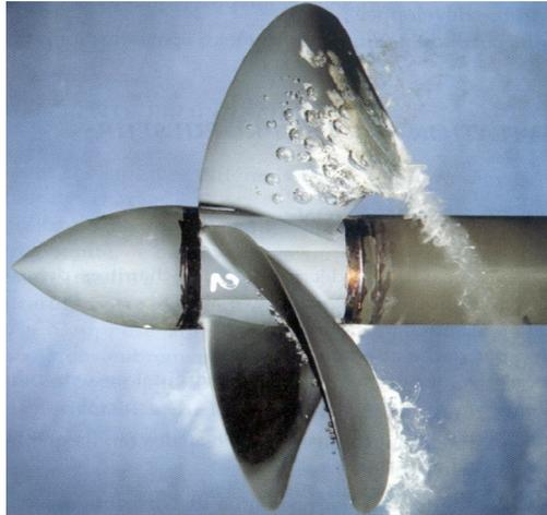
**Fig.2.2-Cavitation à bulles sur une hélice marine. [23]**
