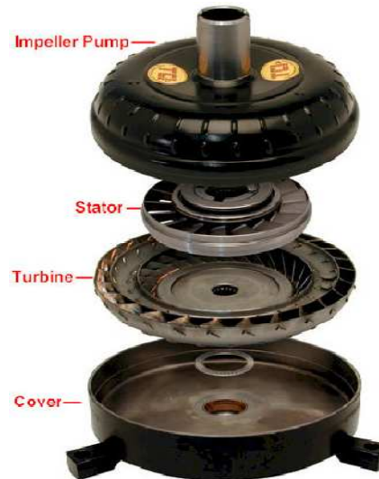
Fig. 17– Composition d'un convertisseur de couple hydraulique [7]
