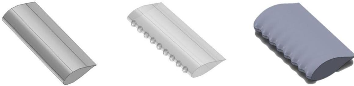
**Fig. 1.4-** Profils aérodynamiques NACA63<sub>4</sub>-421 inspiré des baleines ; *a.* lisse, *b.* sphérique, *c.* ondulé [27]
