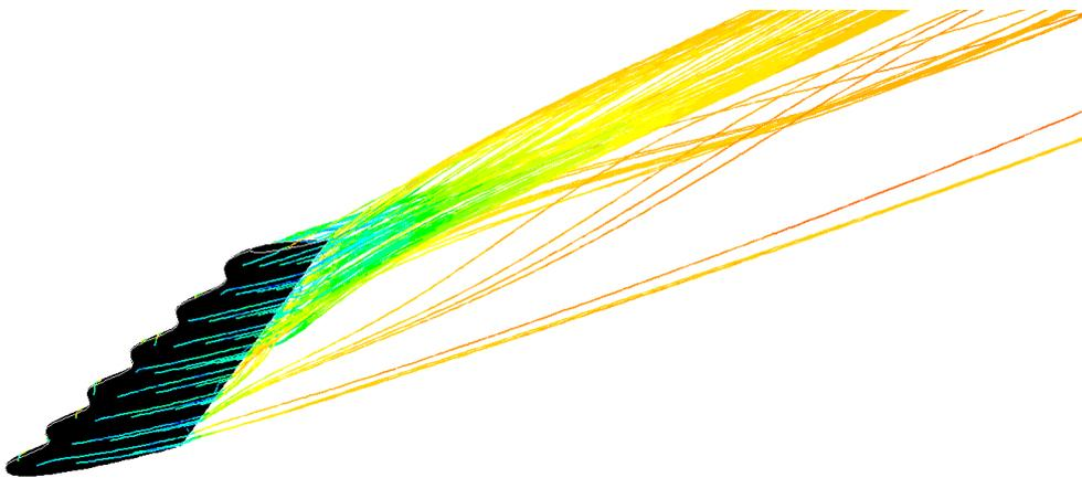
**Fig 4.3-** Lignes de courants colorés par la vitesse de l'écoulement à  $\alpha = 20^\circ$ .
