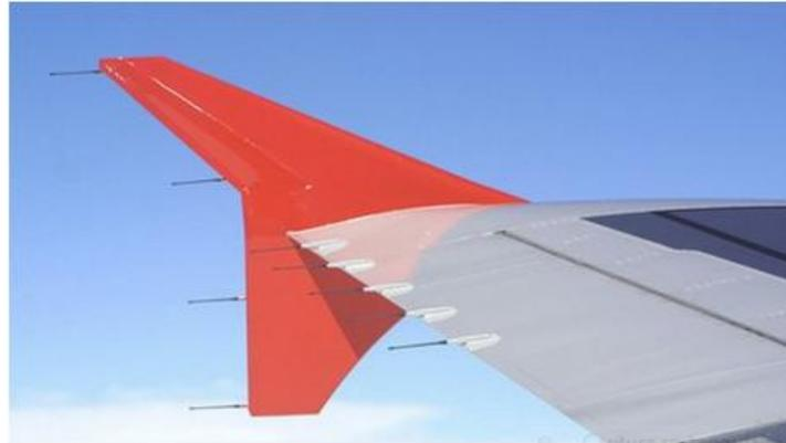
**Fig. 2.9-** Les déperditeurs statiques
