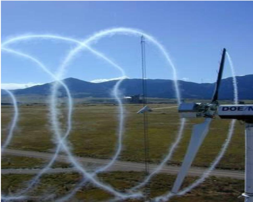
**Fig.21 - Visualisation par dégagement d'un traceur (fumée) du sillage d'une éolienne expérimentale bi-pale. [9]**
