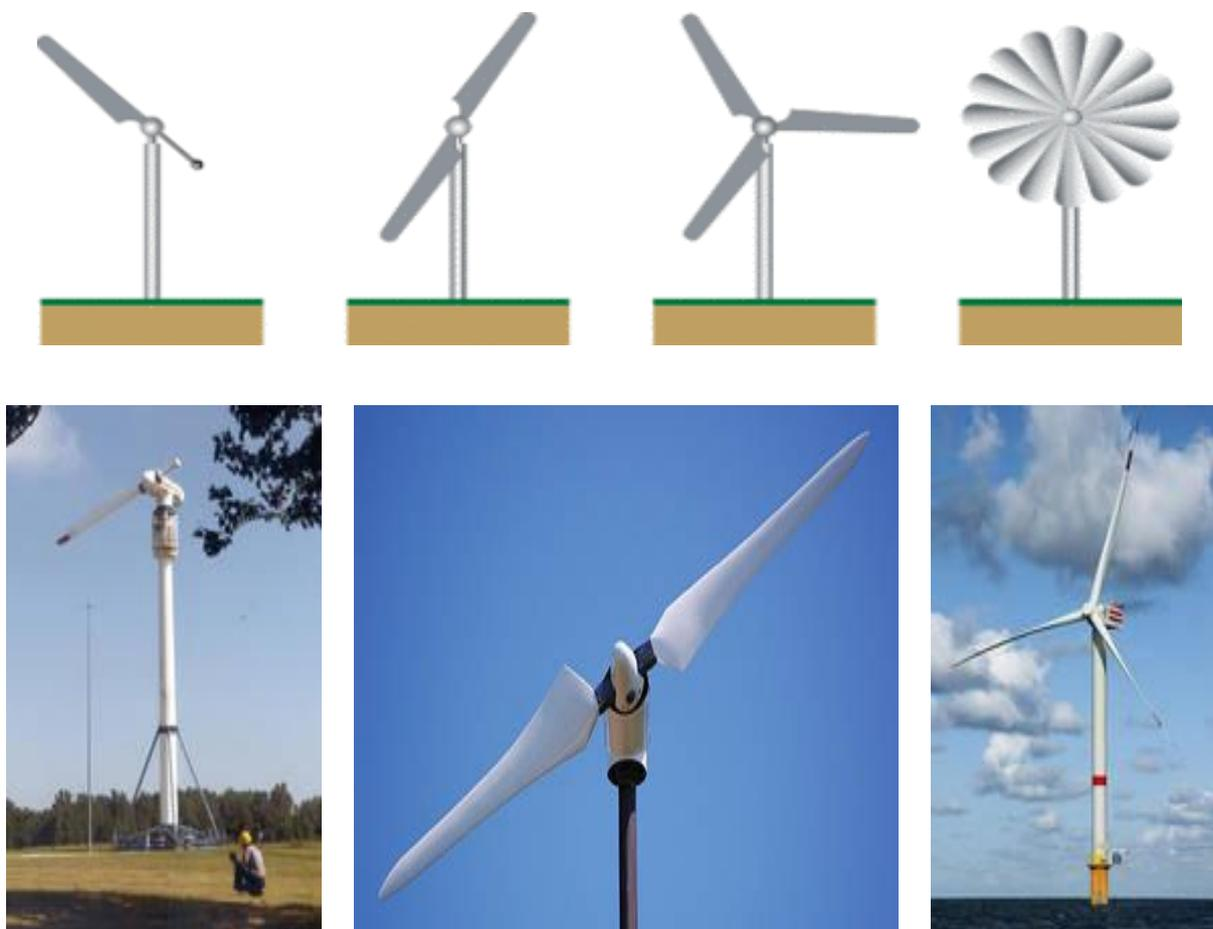
Fig.5 - Distinction entre éoliennes à axe horizontal selon le nombre de pales
