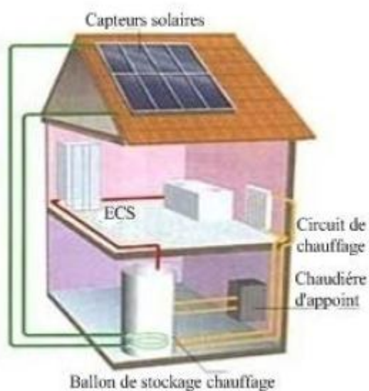
Figure. 17 - Schéma de fonctionnement d'un SSC
