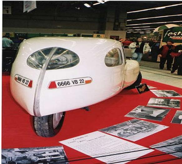
**Fig.5 - Mathis 333, avec sa roue arrière unique [5].**
