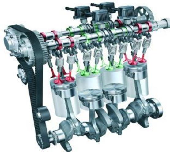
**Fig.1.1** - Transmission par une courroie de distribution.
