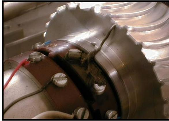
**Fig. 2.4** - Vue du thermocouple dans la dent de la poulie motrice.
