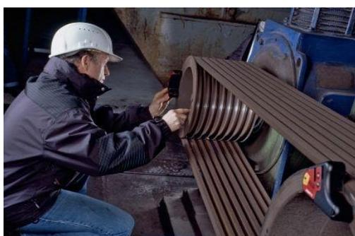
**Fig.1.3** - Courroies trapézoïdales.
