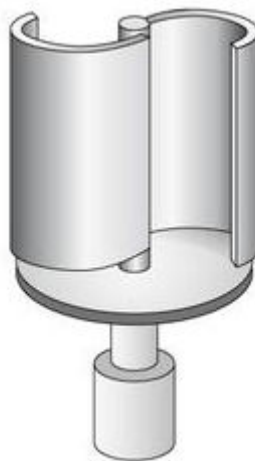
Fig.13-Eolienne à axe vertical de type Savonius [23].
