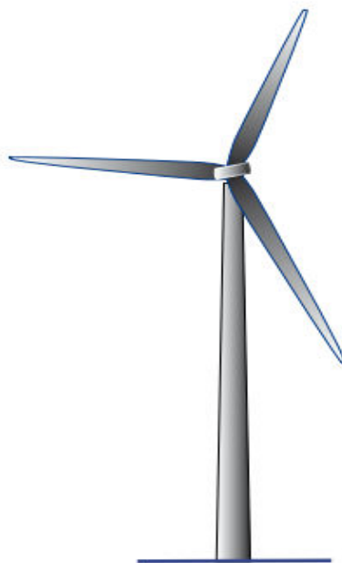
Fig.14-Éolienne à axe horizontal.
