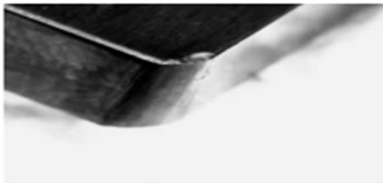
**Figure 1.11 - L'usure par écaillage [24]**
