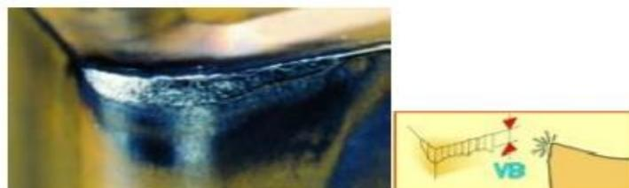
Figure 1.7 -Usure en dépouille [28]
